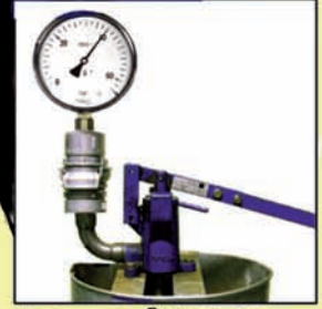
5. CONTRÔLE PAR PRÉLÈVEMENT DE L'ÉTANCHÉITÉ A LA PRESSIION D'ÉPREUVE.
