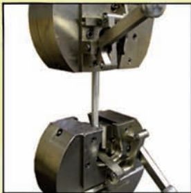
1. CONTRÔLE PERMANENT DE LA MÉTALLURGIE EN COURS DE FABRICATION (TEST DE TRACTION SUR ÉPROUVETTE).
