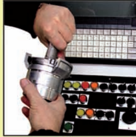
3. CONTRÔLES DIMENSIONNELS PERMANENTS EN COURS D'USINAGE.
