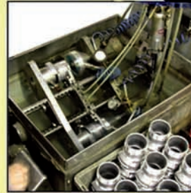
4. CONTRÔLE A 100% DE L'ÉTANCHÉITÉ DES PIÈCES AVANT ASSEMBLAGE FINAL.
